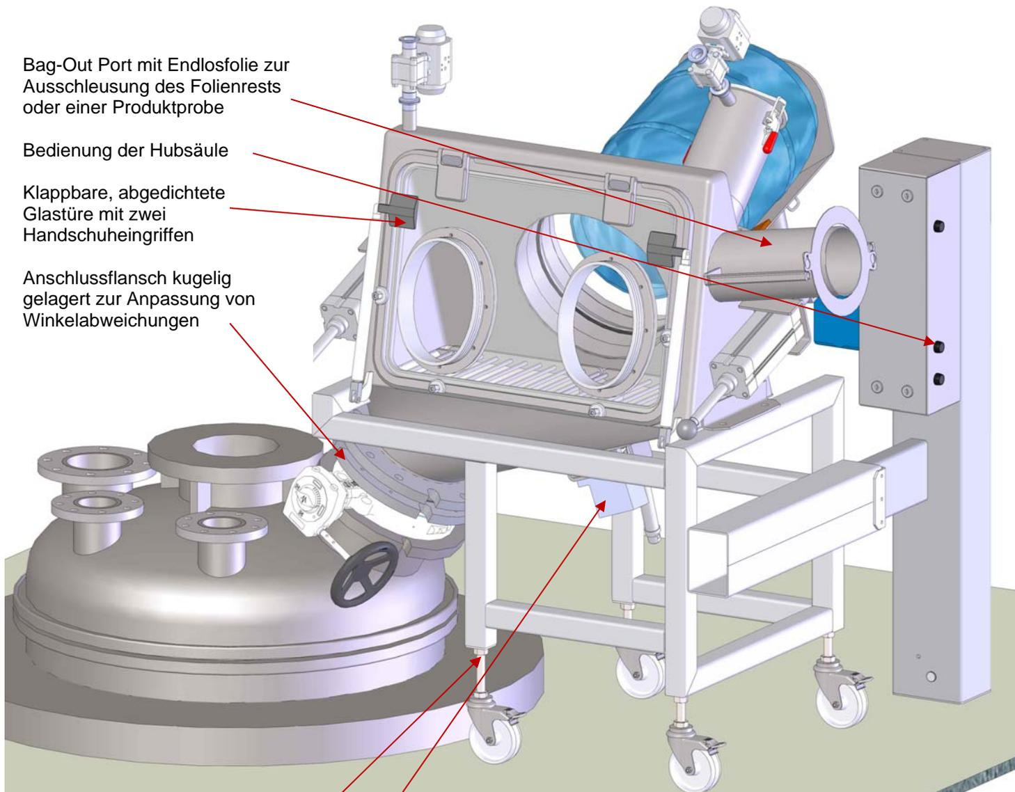
Bag-Out Port mit Endlosfolie zur Ausschleusung des Folienrests oder einer Produktprobe
