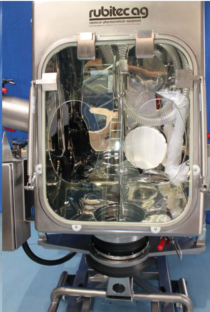
Lanze angeschlossen zum Waschen im Kreislauf
